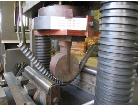
【写真-7 D32（横向き）曲げ試験の状況】
