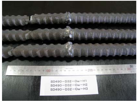
【写真-11 D32 (横向き) 引張試験後】
