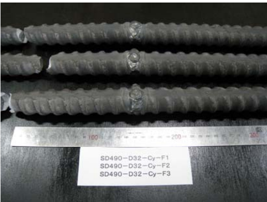
【写真-9 D32 (下向き) 一方向繰返し試験後】
