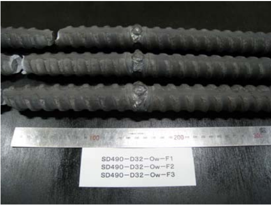
【写真-8 D32（下向き）引張試験後】
