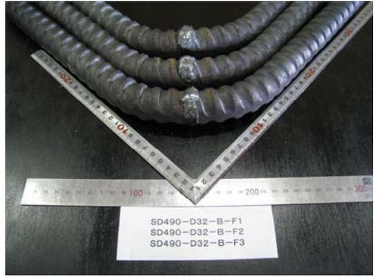
【写真-10 D32（下向き）曲げ試験後】
