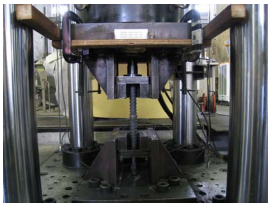
【写真-5 D 3 2 (横向き) 引張試験の状況】
