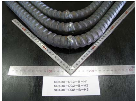
【写真-13 D32 (横向き) 曲げ試験後】
