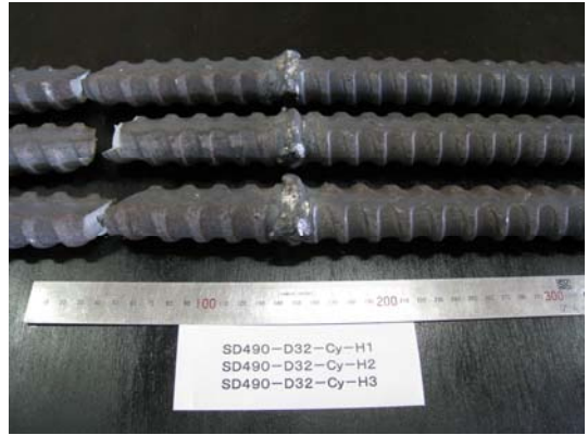
【写真-12 D32（横向き）一方向繰返し試験後】
