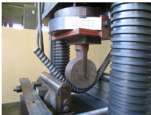
【写真-4 D 3 2 (下向き) 曲げ試験の状況】
