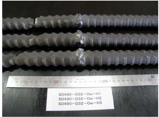
【写真-11 D32（横向き）引張試験後】
