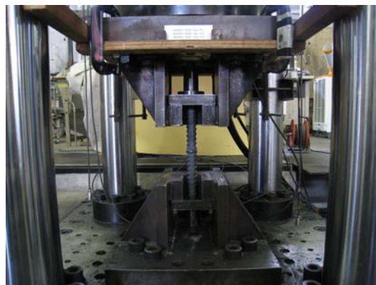
【写真-2 D 3 2 (下向き) 引張試験の状況】
