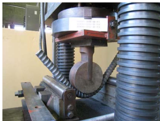
【写真-4 D 3 2 (下向き) 曲げ試験の状況】
