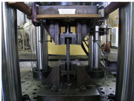
【写真-2 D 3 2 (下向き) 引張試験の状況】
