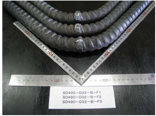
【写真-10 D32（下向き）曲げ試験後】
