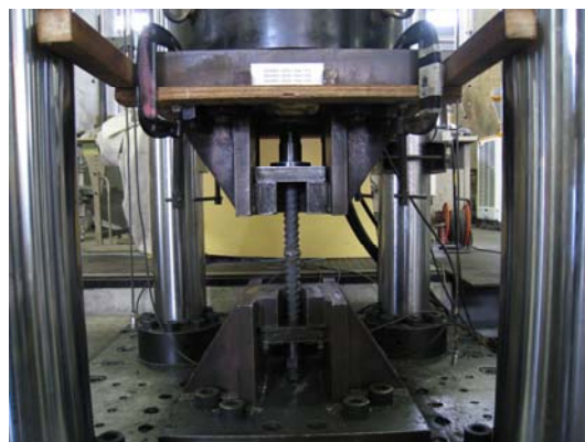
【写真-5 D 3 2 (横向き) 引張試験の状況】
