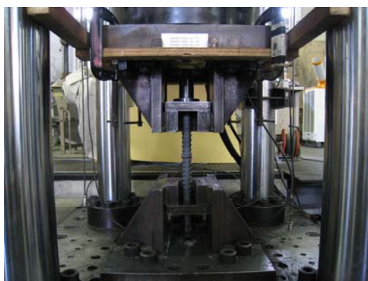
【写真-3 D 3 2 (下向き) 一方向繰返し試験の状況】
