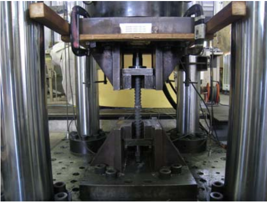
【写真-6 D32（横向き）一方向繰返し試験の状況】
