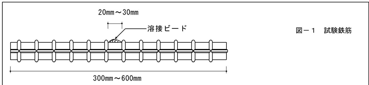
図-1に示すように、鉄筋に溶接ビードをおく。溶接ワイヤまたは溶接棒は実工事に使用するものと同一のものを使わなければならないことは当然である。
