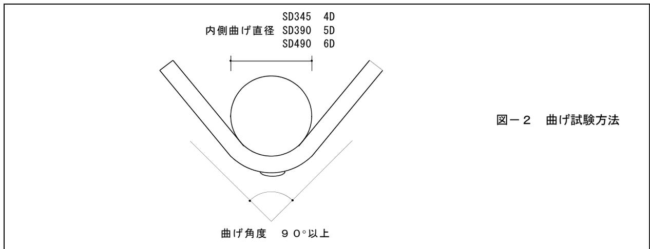
図-2の内側曲げ直径はJISG3112「鉄筋コンクリート用棒鋼」の母材曲げ試験と同一である。この試験で折れるか、割れが生じた鉄筋は溶接性が悪いと判断される。そのような鉄筋の溶接継ぎ手は引張試験でボンド部破断になりやすい。このような継ぎ手はSA級には適合しないが、A級継ぎ手としては使用可能である。
