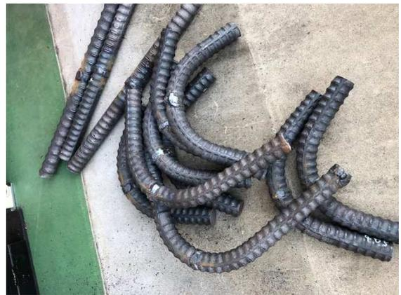
写真一 6 曲げ試験後
