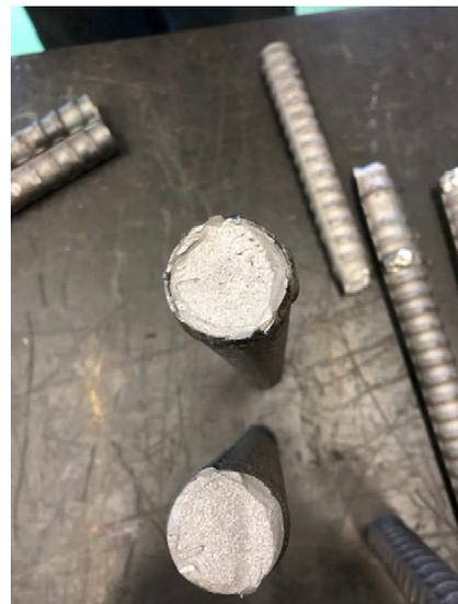
写真一 8 溶接不良（スタート時不良）
