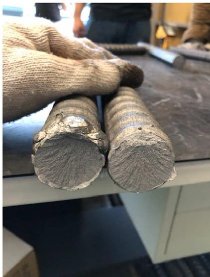
写真一 7 溶接不良（クレータ処理不良）
