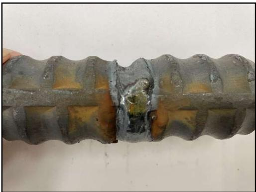
写真-3. 3 余盛高さが鉄筋径より低い
