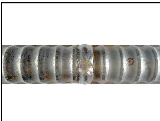
写真-1. 3 下向き溶接裏側
