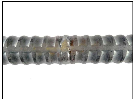
写真-2. 2 横向き溶接横側
