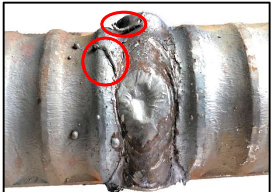
写真-3. 8 ワイヤ溶け残り
