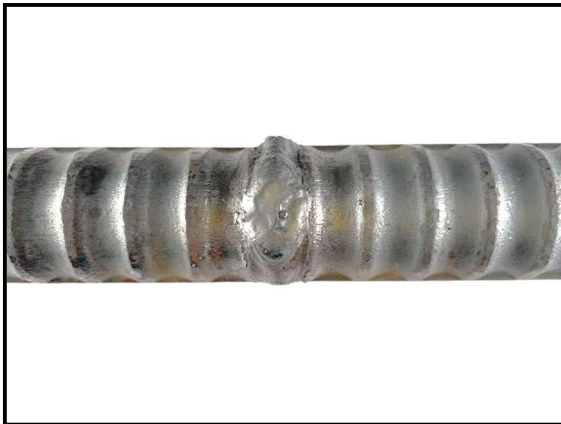
写真-1. 1 下向き溶接表側
