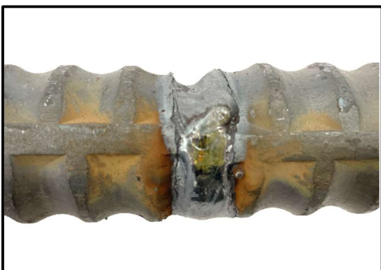
写真-3. 4 余盛高さが鉄筋径より低い
