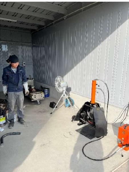
写真-3 溶接した鉄筋の曲げ試験
