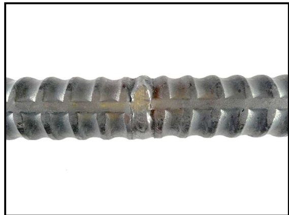
写真-2. 2 横向き溶接横側
