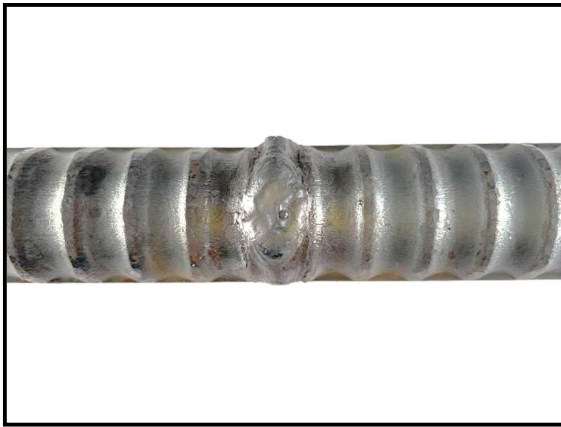
写真-1. 1 下向き溶接表側
