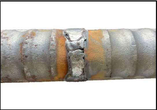
写真-3. 3 溶け込み不足
