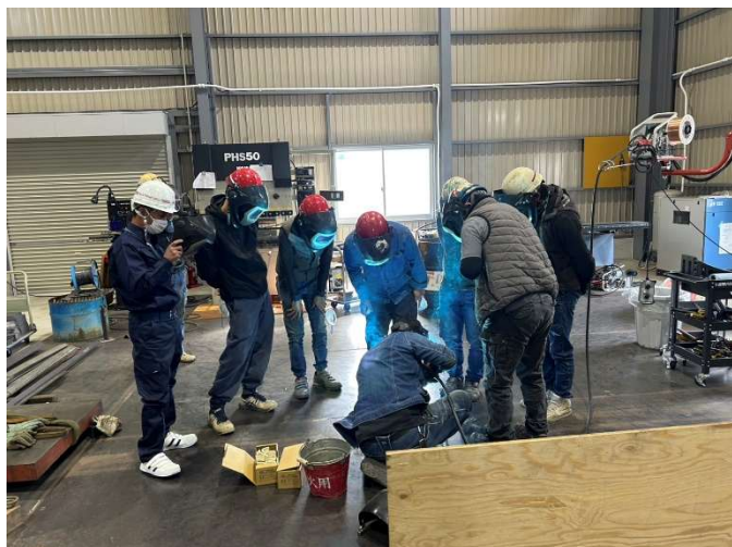
写真-1 SD390 D41 タケ節 梁向き溶接
