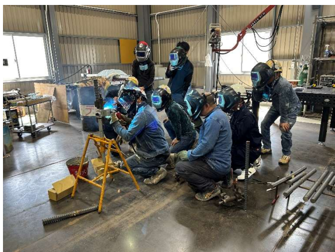
写真-3 SD390 D41 タケ節 柱向き溶接
