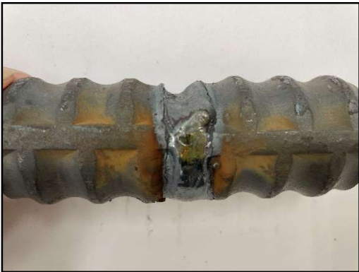
写真—3. 3 余盛高さが鉄筋径より低い
