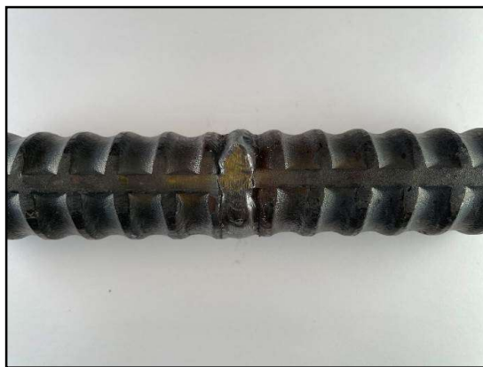
写真—2. 2 横向き溶接横側
