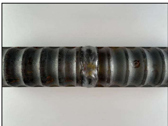
写真—1. 3 下向き溶接裏側
