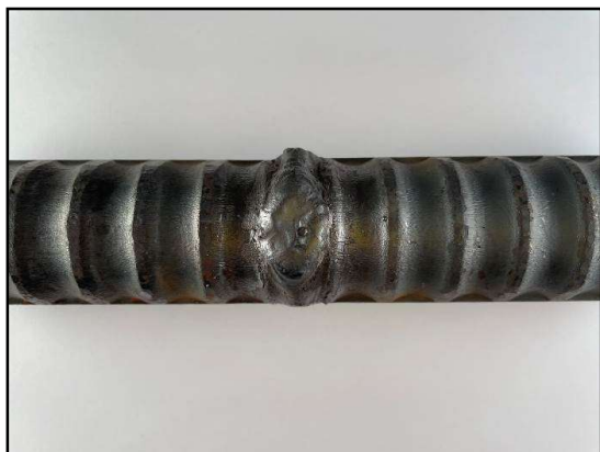
写真—1. 1 下向き溶接表側
