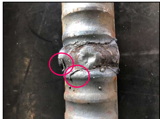
写真—3. 8 ワイヤ溶け残り
