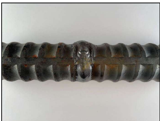
写真—1. 2 下向き溶接横側
