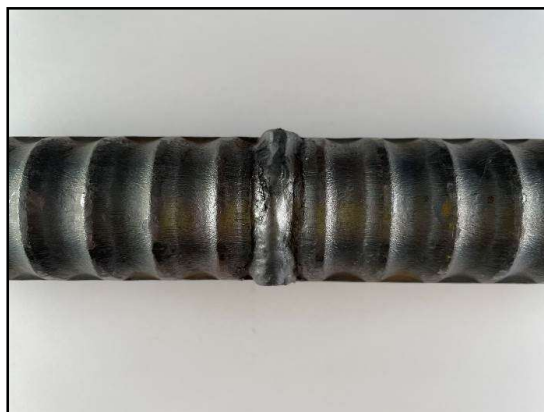
写真—2. 1 横向き溶接表側
