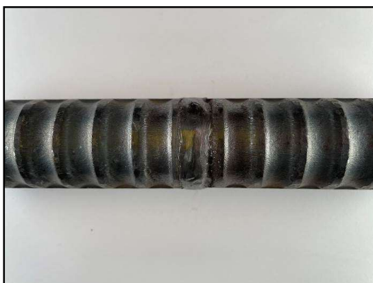
写真—2. 3 横向き溶接裏側
