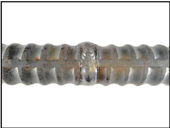
写真－1. 2 下向き溶接横側
