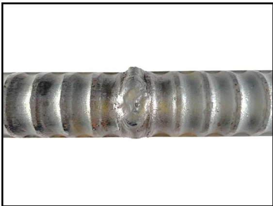
写真－1. 1 下向き溶接表側
