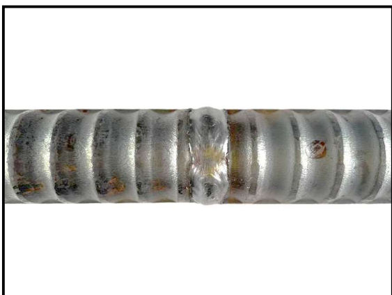
写真－1. 3 下向き溶接裏側
