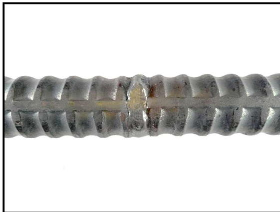
写真－2. 2 横向き溶接横側
