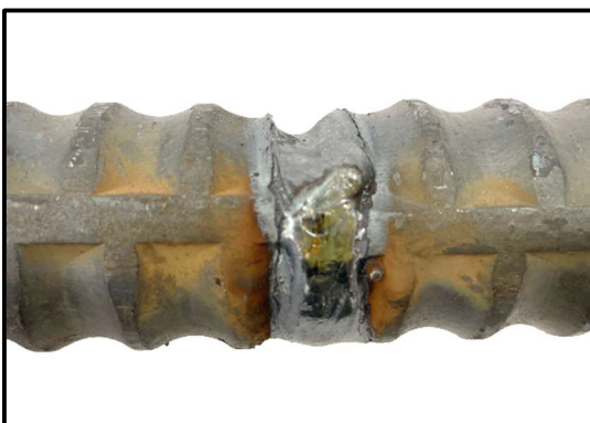
写真－3. 4 余盛高さが鉄筋径より低い
