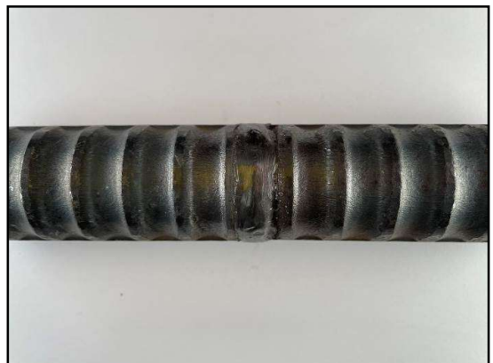
写真-2. 3 横向き溶接裏側
