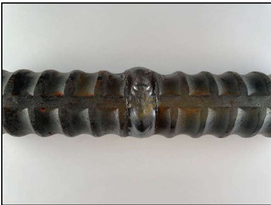
写真-1. 2 下向き溶接横側
