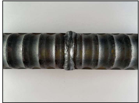
写真-2. 1 横向き溶接表側
