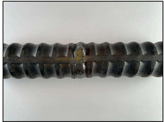
写真-2. 2 横向き溶接横側
