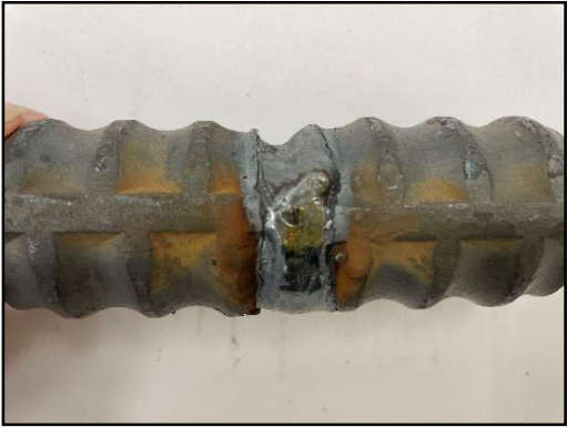
写真-3. 3 余盛高さが鉄筋径より低い
