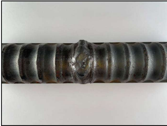
写真-1. 1 下向き溶接表側
