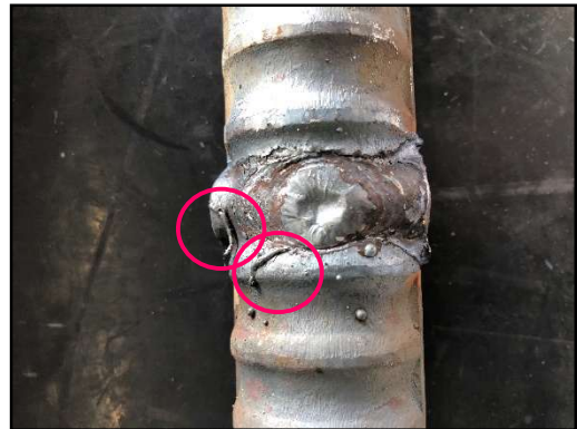
写真-3. 8 ワイヤ溶け残り
