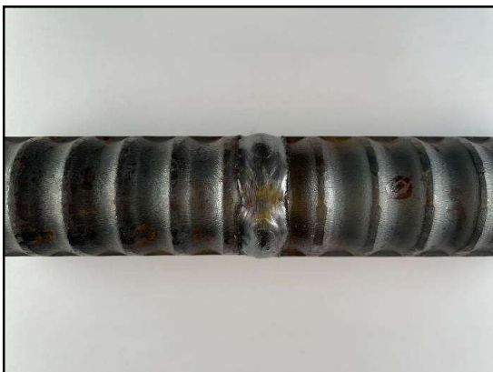
写真-1. 3 下向き溶接裏側
