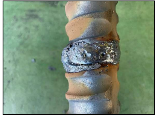
写真-3. 7 外部ブローホールおよび垂れ
