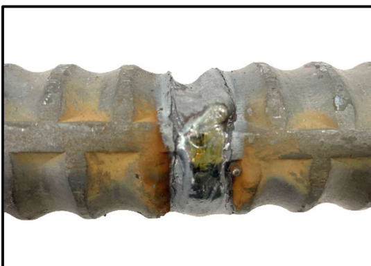
写真－3. 4 余盛高さが鉄筋径より低い
